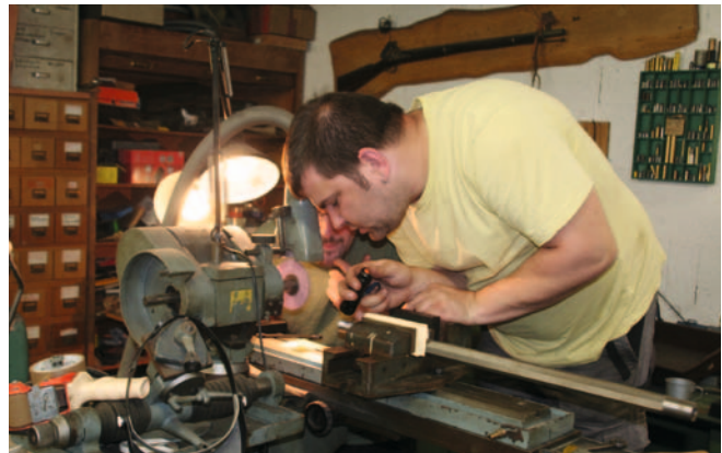
Timo Keßel (mittlerweile Meister) bringt an dem eingespannten Eichelberger-Lauf den richtigen Radius der Auswerfernut ein.
