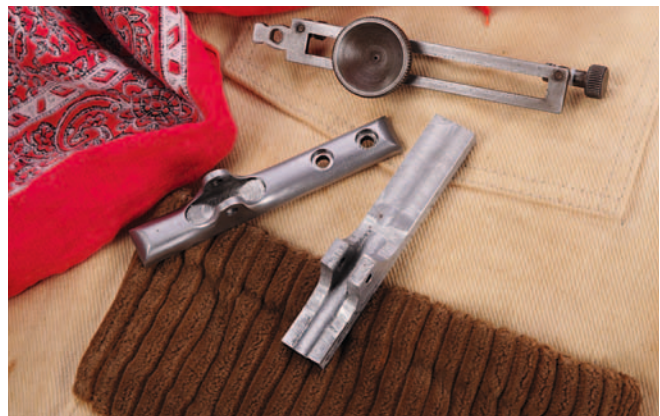
Unter dem Diopter mit der runden Irisblende liegen links der fertige Montagesockel und rechts daneben eine noch roh belassene Vorstudie für dieses Element.
