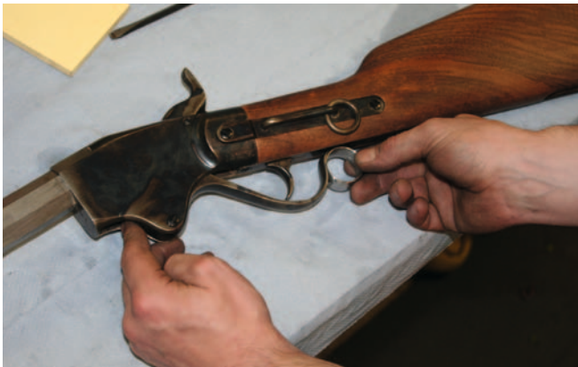
Und immer wieder probieren – hier geht es darum, ob der typische Ring-Lever richtig an der Systemunterseite sitzt.
