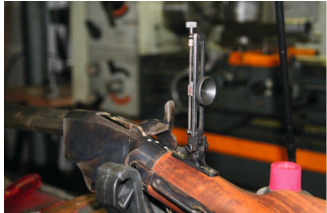
Passt auch auf die Spencer drauf: Ein Kolbenhalsdiopter mit Stellspindel und muschelförmiger Irisblende – hier probeweise in der Werkstatt montiert. Darunter sieht man noch die Carbine-Reitstange – diese wurde von Helbach entfernt.
