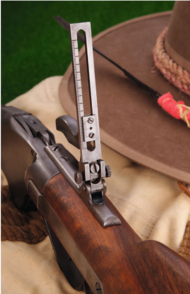
Nur nach Bildvorlagen rekonstruierte Helbach dieses Klappdiopter. Auch der so simpel aussehende Montagesockel erforderte jede Menge Vorplanung und genaueste Passarbeit.
